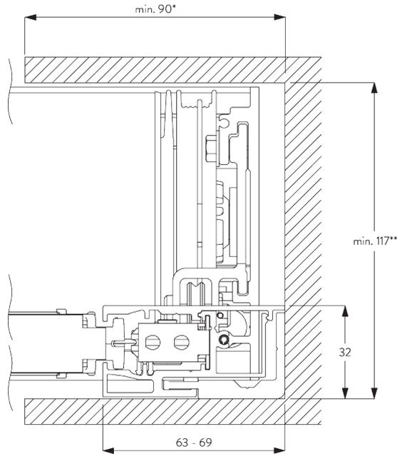
\*Nischentiefe erforderlich, um die Enddeckel des Beschwerungsprofils vollständig zu verdecken
